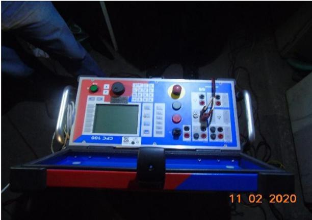
**Pruebas de nivel de Aislamiento del cableado de potencia a 13.200 V**
